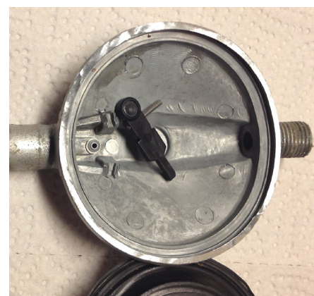
Bild 3. Den lösa regulatormekanismen med sina deformerade axelfästen. Den svarta delen i mitten är hävarmen med förskjutet axel och gummipackning. Längst ner skymtar membranet.
