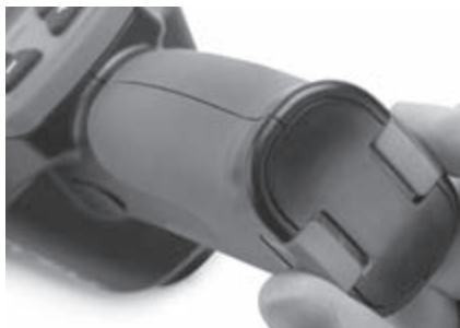
Figur 3 – Lock över batteriutrymmet
