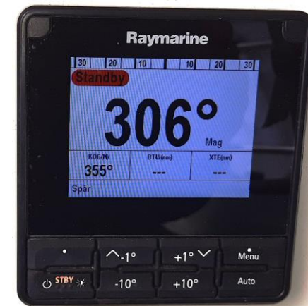
Raymarine autopilot p70 med gyrokompass. Nätverk Seatakn ng
