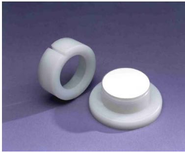
Figur 5. DGT (Diffusive Gradient Thin film). Det vita membranet består av en katjonbytare som ackumulerar metalljoner.
