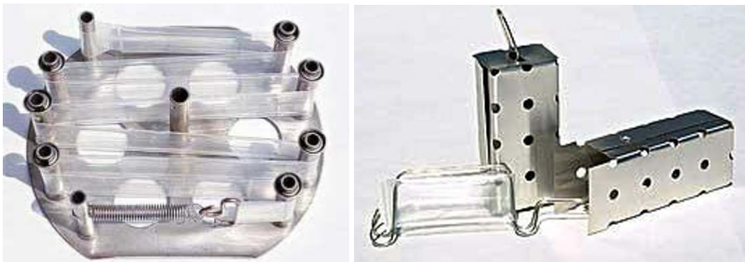
Figur 6. SPMD (semipermeable membrane device) består av en slang fylld med ett fett (triolein). Slangen har små porer där organiska fettlösliga substanser kan passera.
