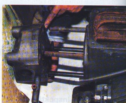
När topplocket skulle lossas fattades 5-6 mm i avstånd för att de nedre pinnskruvarna från cylindern skulle gå fria.
