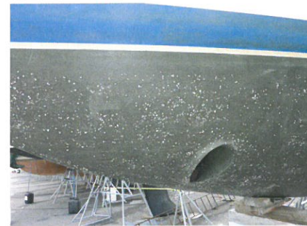
Båten på bilden till höger är rustad efter måla mindre-principen och är fri från beväxning till skillnad från båten till vänster som har gammal färg. Foto: Lennart Falck
