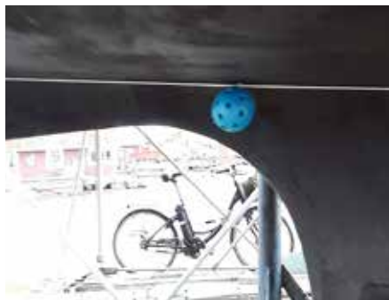
Fyra DTG-sonder monterades i varsin innebandyboll på fyra ställen intill den nymålade kopparfärgen.
