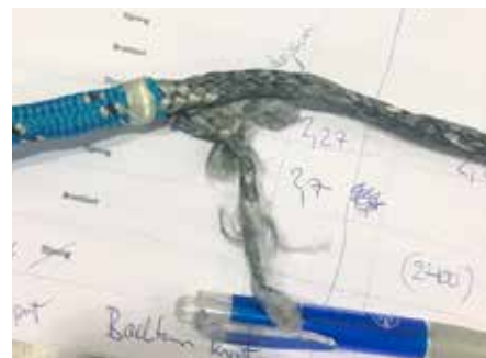
Splisat Dyneema-fall efter provet.
