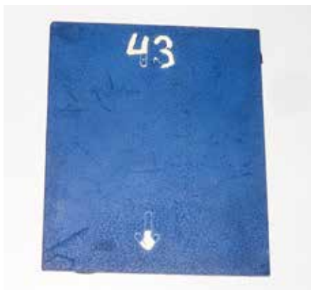
Fyra provplattor (10x12 cm) monterades ca 30 cm under vattenlinjen, två på varje sida av rodet.
