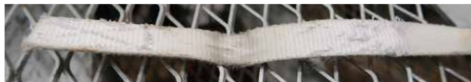
Öglor på band bör sys med raka stygn längs med bandet, inte tvärs.
