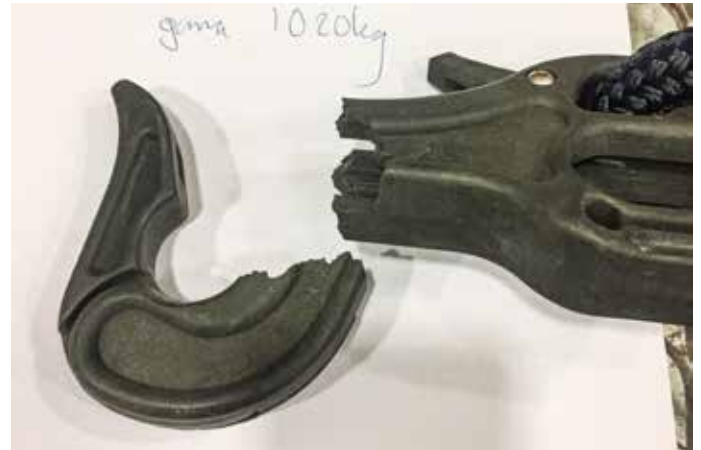
Bojkrokarna drogs tills de gick sönder vid ca 1000 kilos belastning, vilket borde vara mer än tillräckligt vid tillfällig förtöjning.
