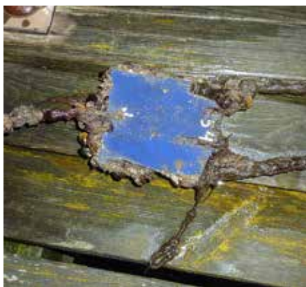
Några fasta provplattor monterades vid tre bryggplatser där provbåtar var förtöjda.
