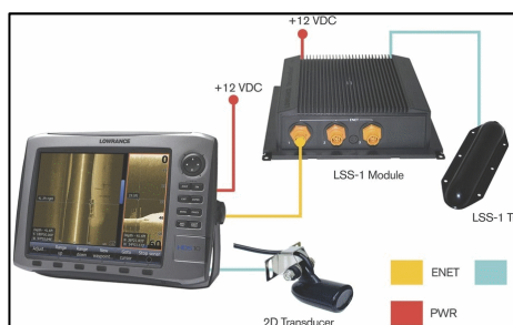
Ett komplett Lowrance-system med både SideScan och vanligt ekolod (2D)
