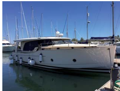
En några år gammal Greenline 40 Hybrid fick Skepparen och Styman till slut tag i i södra Frankrike. Hybrid innebär att de båda 110 kW dieslarna kompletteras med två elmotorer om vardera 10 kW.
