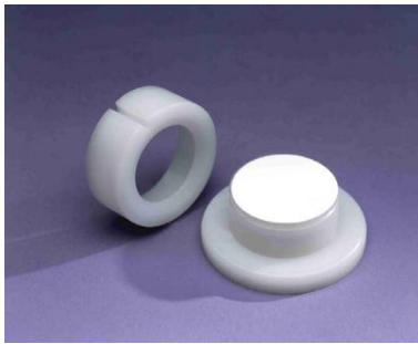
Figur 4. DGT (Diffusive Gradient Thin film). Det vita membranet består av en katjonbytare som ackumulerar metalljoner.
